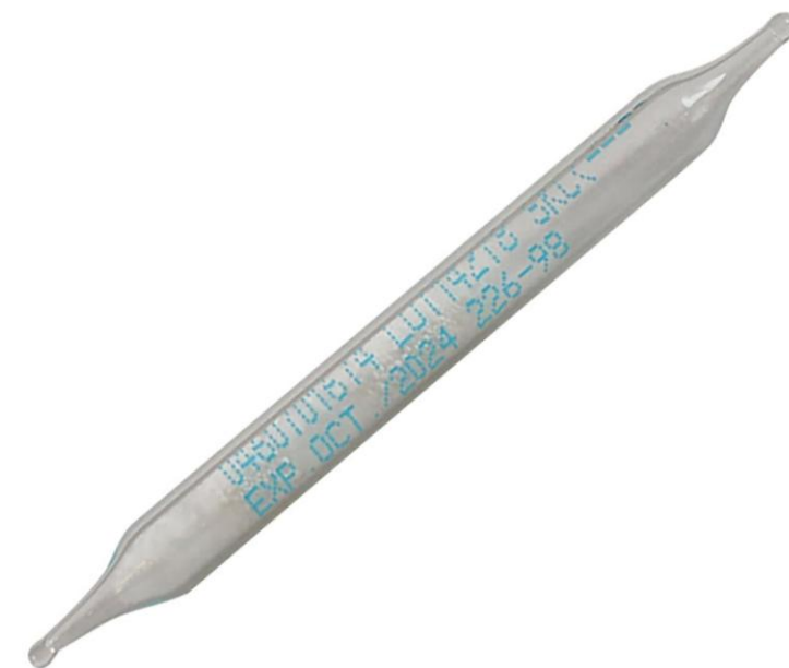
Tube XAD-7 traité H_3PO_4 , 80/40 mg, 6X70mm, Labo sous-traitant USA
