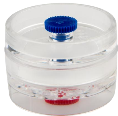
Cassette 37 mm avec FFV imprégné de H_2SO_4
